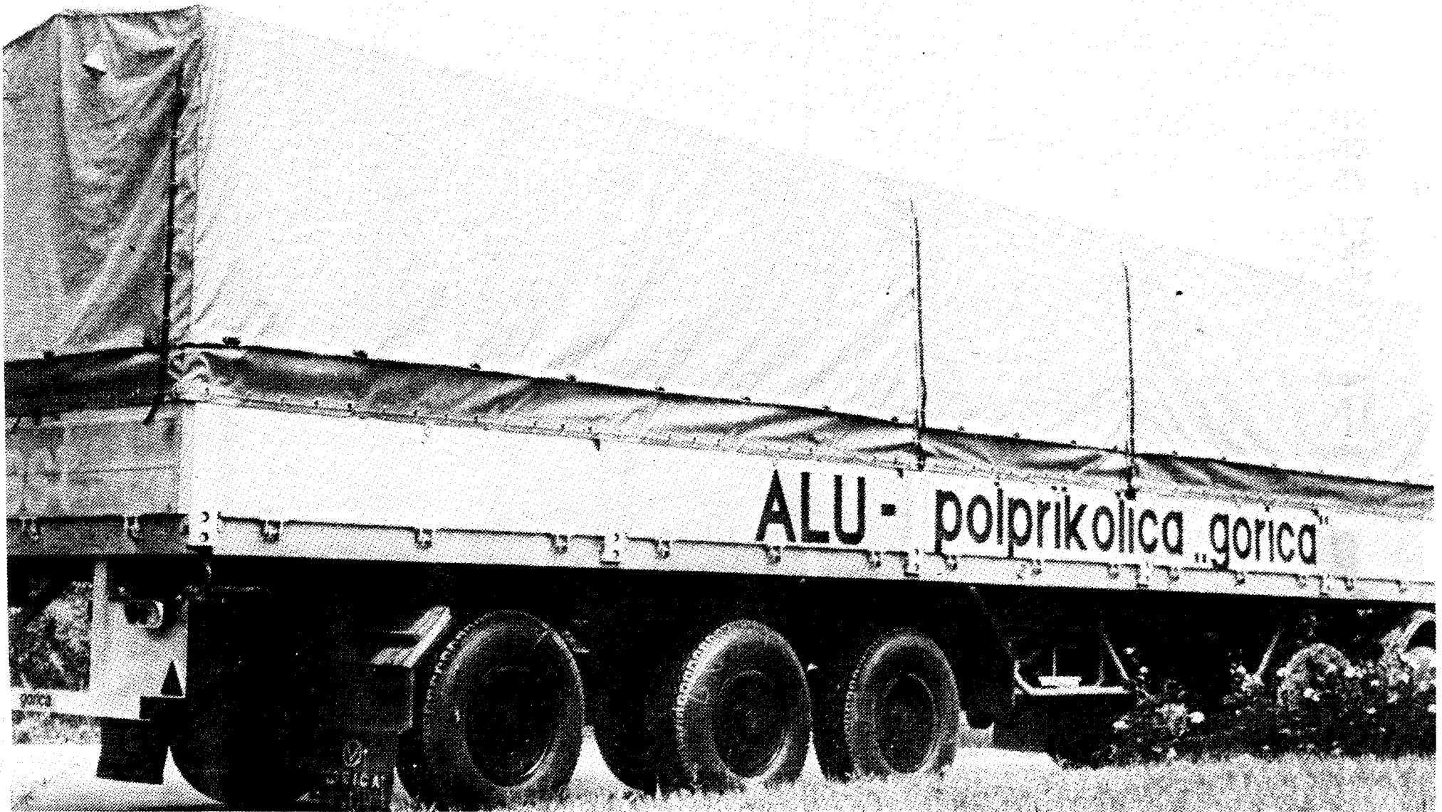
ALU – polprikolica „GORICA“, nosilnost 26 t (v celoti izdelana iz aluminija)
