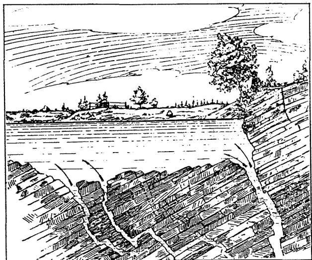
Shema izvira tretjega rokava izliva Timava. V nasprotju z domnevo o tokovih, kanaliziranih po rovu, se tukaj kaže drugačno prepričanje, in sicer o »vzpenjajoči se« vodi po razčlenjenih sistemih številnih rogov (po E. Boeganu iz 1938).
